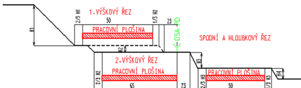
Obr. 2.1 Minimální šířka pracovní plošiny rýpadla SchRs 1550
